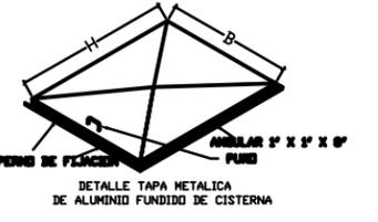
DETALLE TAPA METALICA DE ALUMINIO FUNDIDO DE CISTERNA
